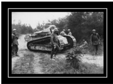
Ein französischer Tank mit drehbarem Panzerturm.
