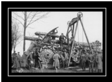
Eine schwere Kanone wird mit Hilfe eines Hebekrans vom Rohrwagen auf die Lafette gehoben.
