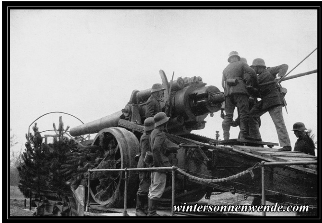
Deutsche 17-cm-Schnelladekanone (Steilfeuer) auf Eisenbahnwagen. Das Wischen des Rohres nach dem Abschuß.
