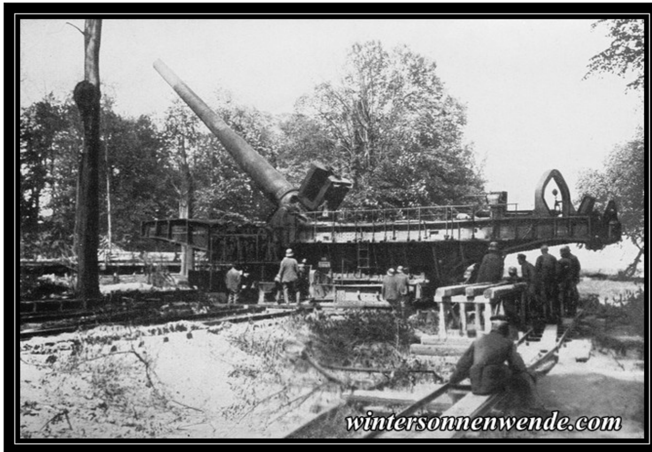
Deutsche 38-cm-Schnelladekanone, Eisenbahnbettungsgeschütz, zum Abschluß fertig. (Zeitweilige Stellung im Parke einer Zuckerfabrik, westlich Lille.)
