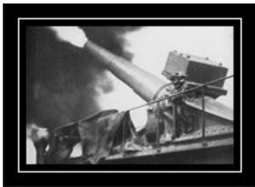
Der Abschluß eines deutschen 24-cm-Eisenbahngeschützes vor Verdun 1916.
